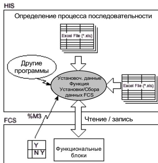
**Рисунок** Функция установки / сбора данных FCS
