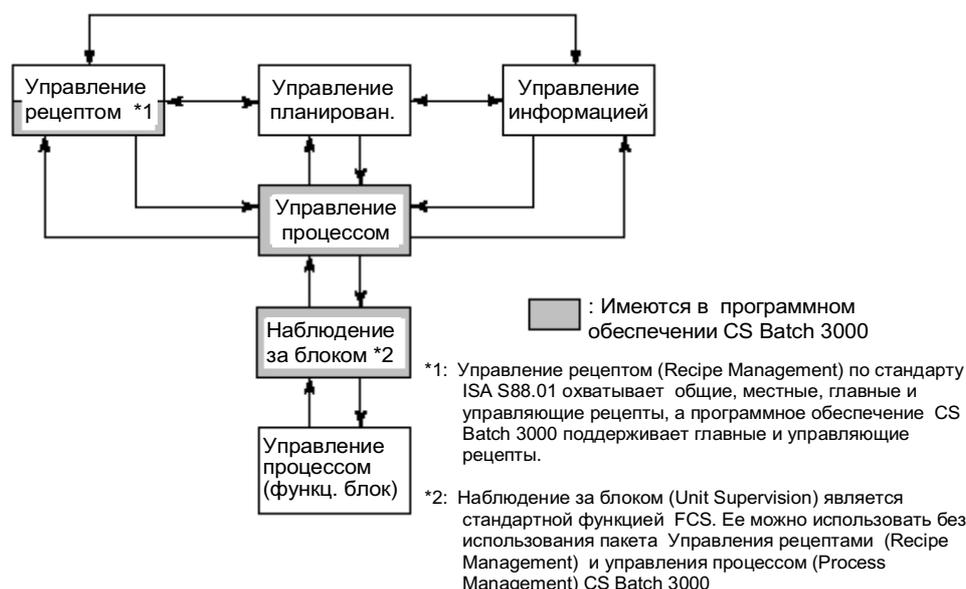
**Рисунок Модель активного управления по стандарту ISA S88.01 и пакет CS Batch 3000**
