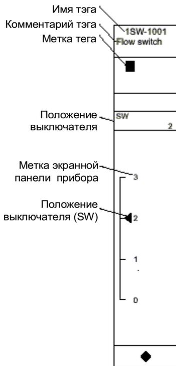
Рисунок Трехполосный трехпозиционный блок селекторного переключателя SW-33
